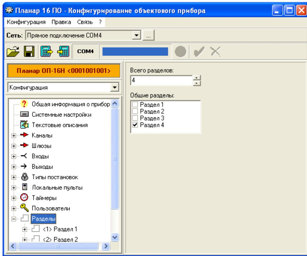
Типовое окно программы конфигурирования объектового прибора при выборе разделов связанных с общим и выбора типа постановки показано ниже.
