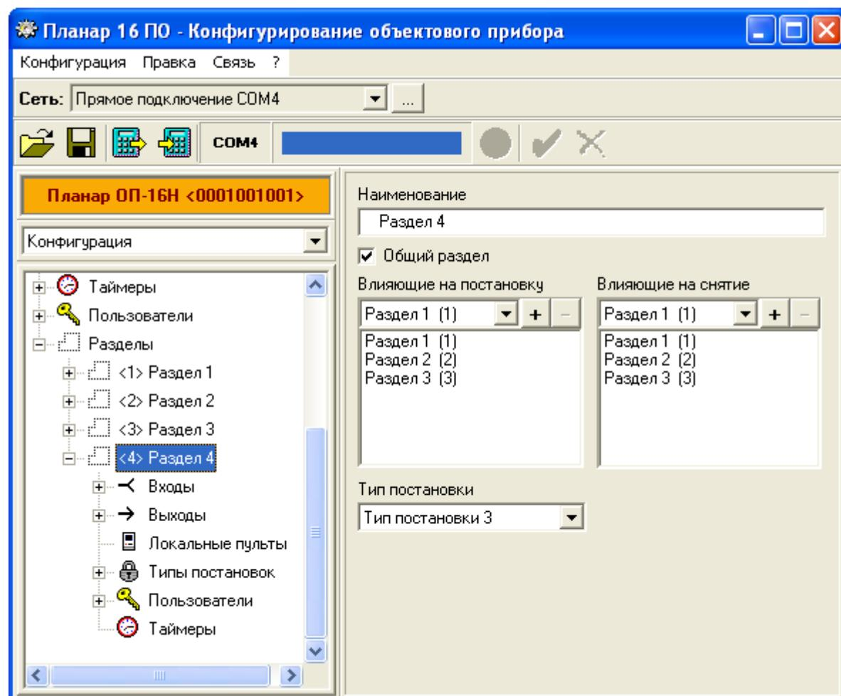
Для добавления раздела в список разделов связанных с общим на постановку и снятие, выделите его в выпадающем списке (нажав кнопку ) и добавьте раздел кнопкой . Для удаления раздела из списка разделов связанных с общим на постановку и снятие, выделите раздел в этом списке и удалите его кнопкой .
