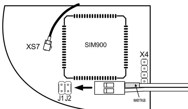
Рисунок 15.4 – Подключение термодатчика
