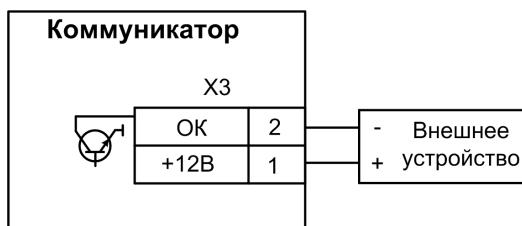
Рисунок 15.2 – Схема подключения внешнего устройства к коммуникатору
