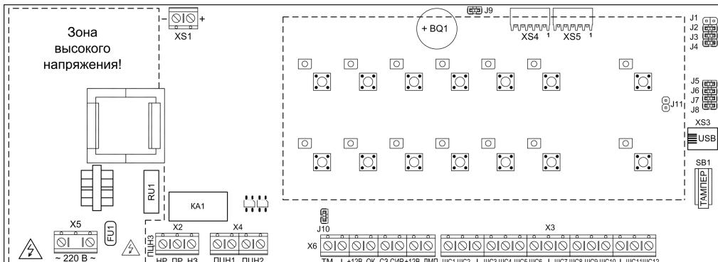
Рисунок 4.1 – Внешний вид платы прибора Гранит-12
