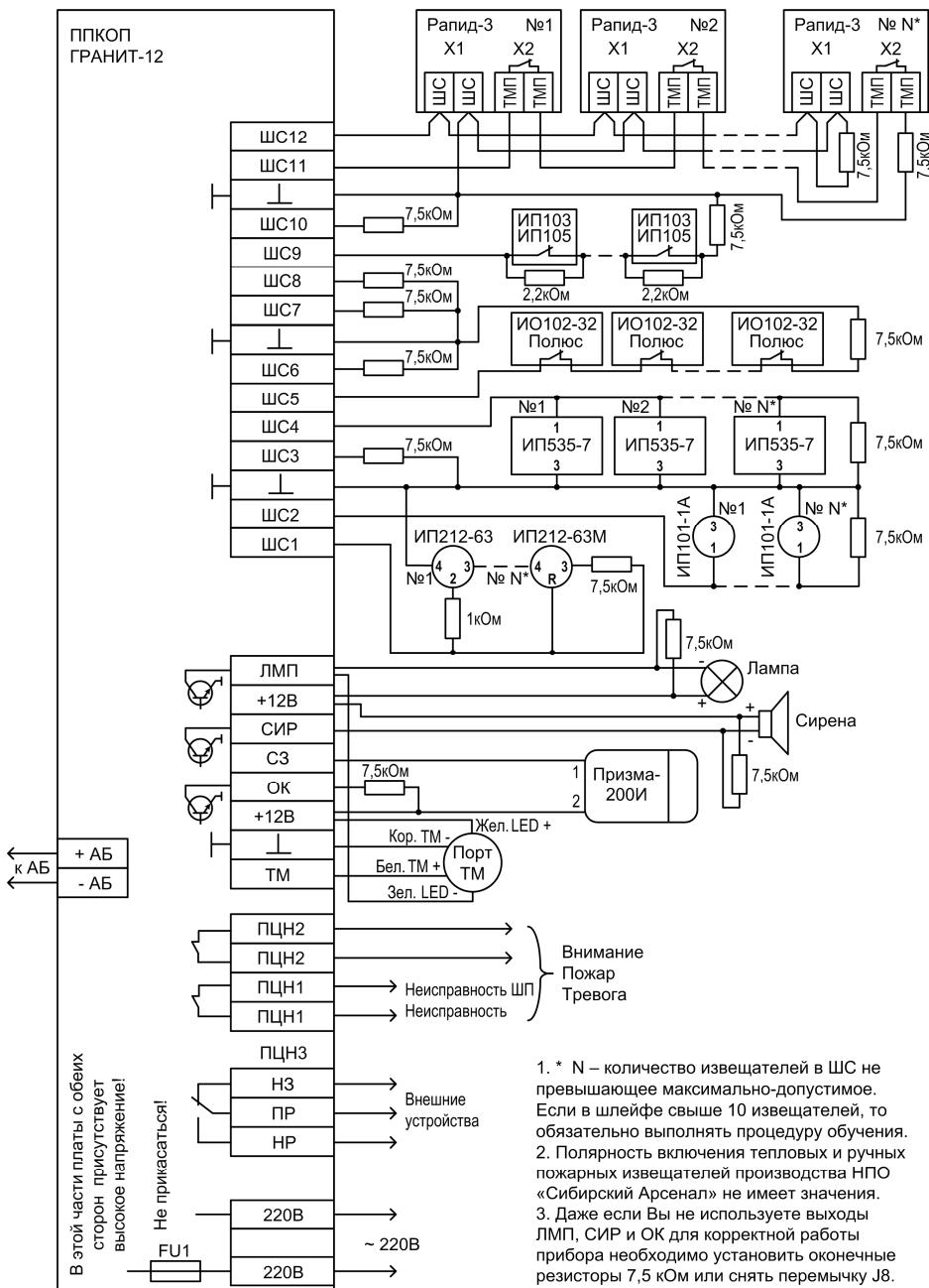
Рис.25.1 Рекомендуемая схема внешних подключений на примере ППКОП Гранит-12
