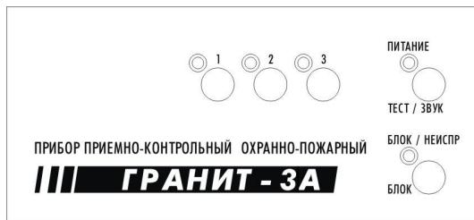
**Рисунок 4.2 – Панель управления ППКОП «Гранит-ЗА»**
