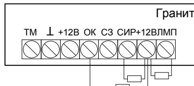
Рисунок 4.3 – Схема подключения резисторов
