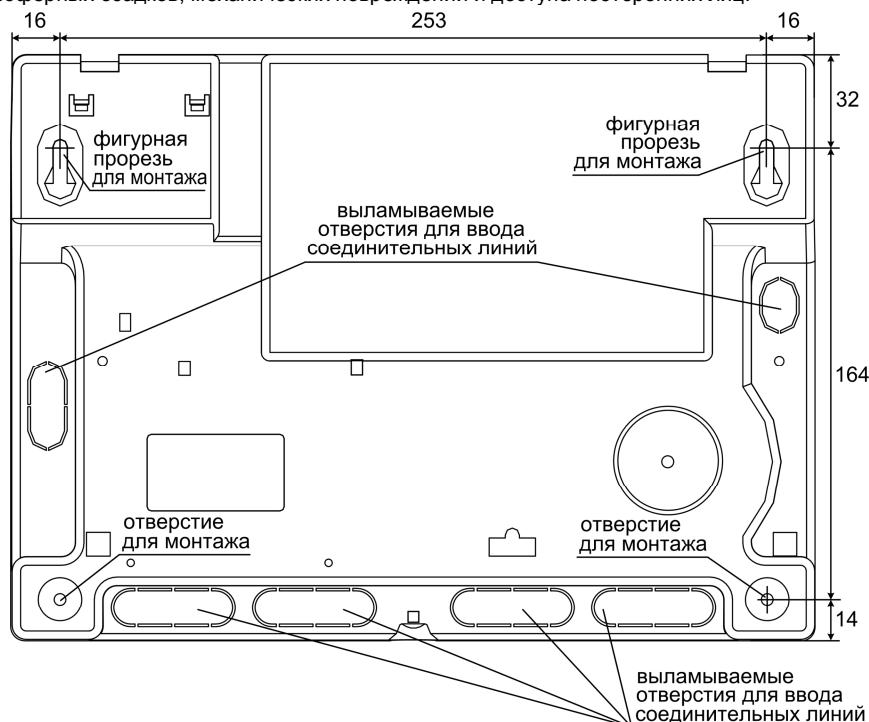
Рисунок 5.1 – Задняя стенка прибора. Присоединительные размеры
