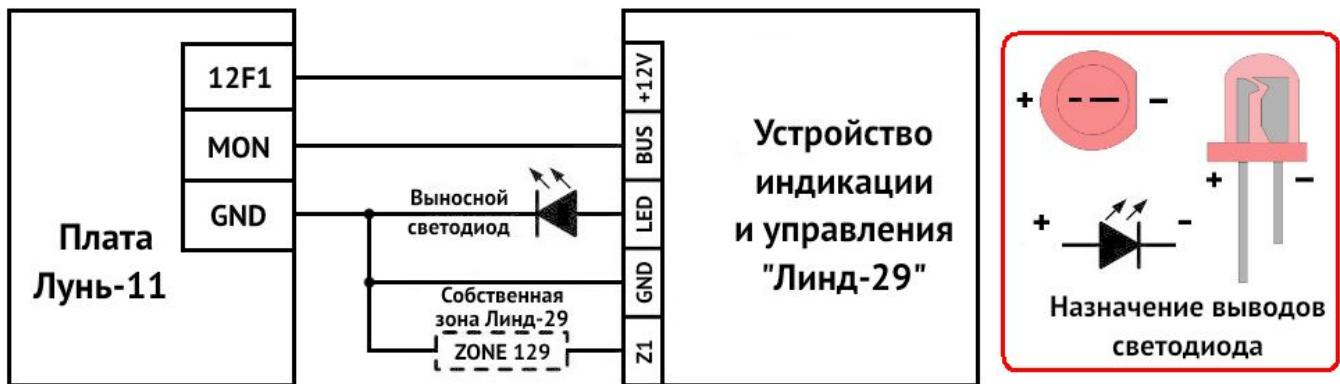
Рисунок 5. Схема подключения УИУ к ППК «Лунь-11»
