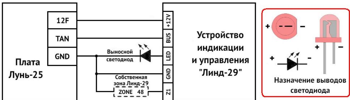
Рисунок 6. Схема подключения к ППК «Лунь-25»
